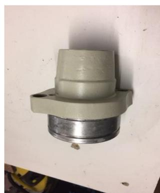
**Propellerwellen-Flansch Volvo Penta AQ 290 DP**
